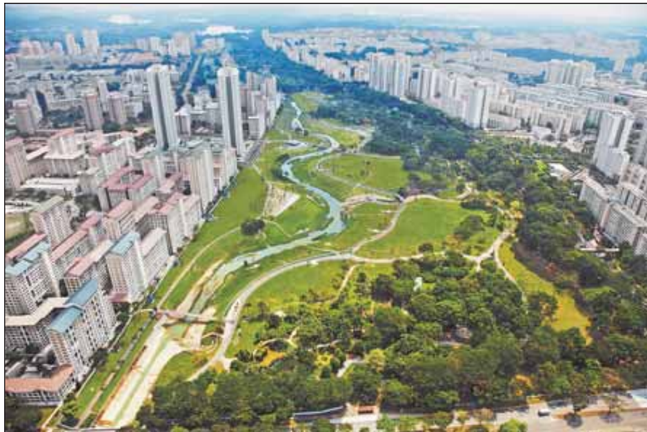
Früher verlief im Bishan Park in Singapur – ein Inselstaat ohne natürliche Wasservorkommen – ein Betonkanal. Herbert Dreiseitls Büro gestaltete eine Flusslandschaft, die der Trinkwasserversorgung und dem Hochwasserschutz dient. Foto: Ramboll
